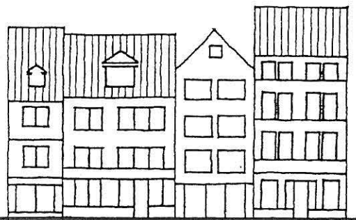
BILD 3 DER WECHSEL DER FIRSTRICHTUNG INNERHALB EINER GEBÄUDEZEILE STÖRT DIE HARMONIE. EIN WECHSEL DER FIRSTRICHTUNG IST DESHALB UNZULÄSSIG.
